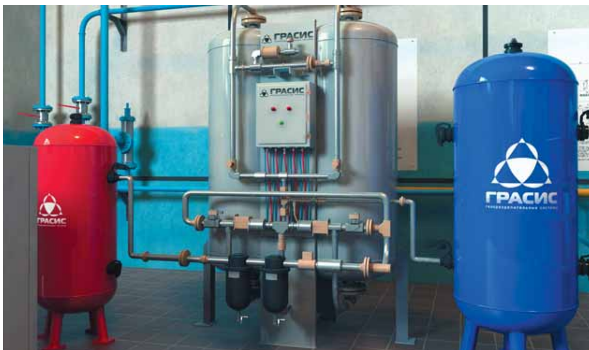
Производительность — 18 нм 3 /ч, чистота кислорода — 93-95%.
