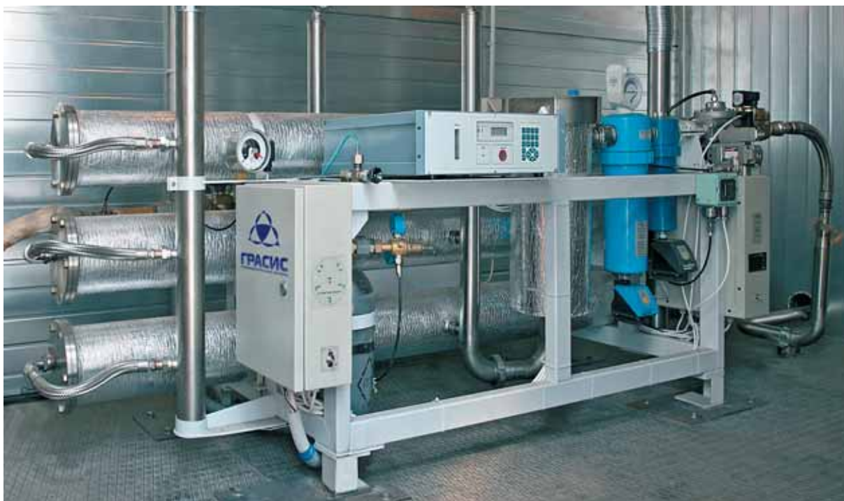
Заказчик — ОАО «Газпром». Производительность — 370 нм 3 /ч, чистота кислорода — 37%.
