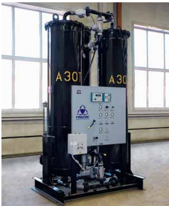
Заказчик — ОАО «Тюльская топливно-энергетическая компания». Производительность — 50 нм 3 /ч, чистота азота — 99.95%.
