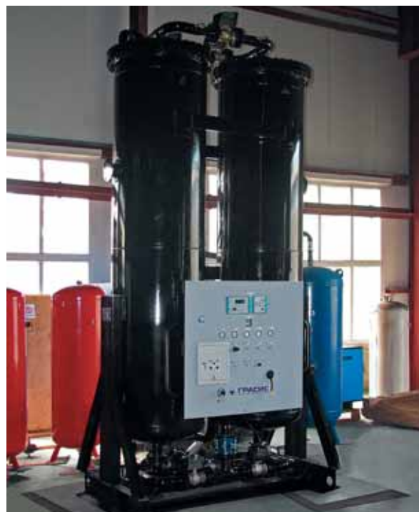
Заказчик — ОАО «Чепецкий механический завод». Производительность — 300 нм 3 /ч, чистота азота — 99.9%.
