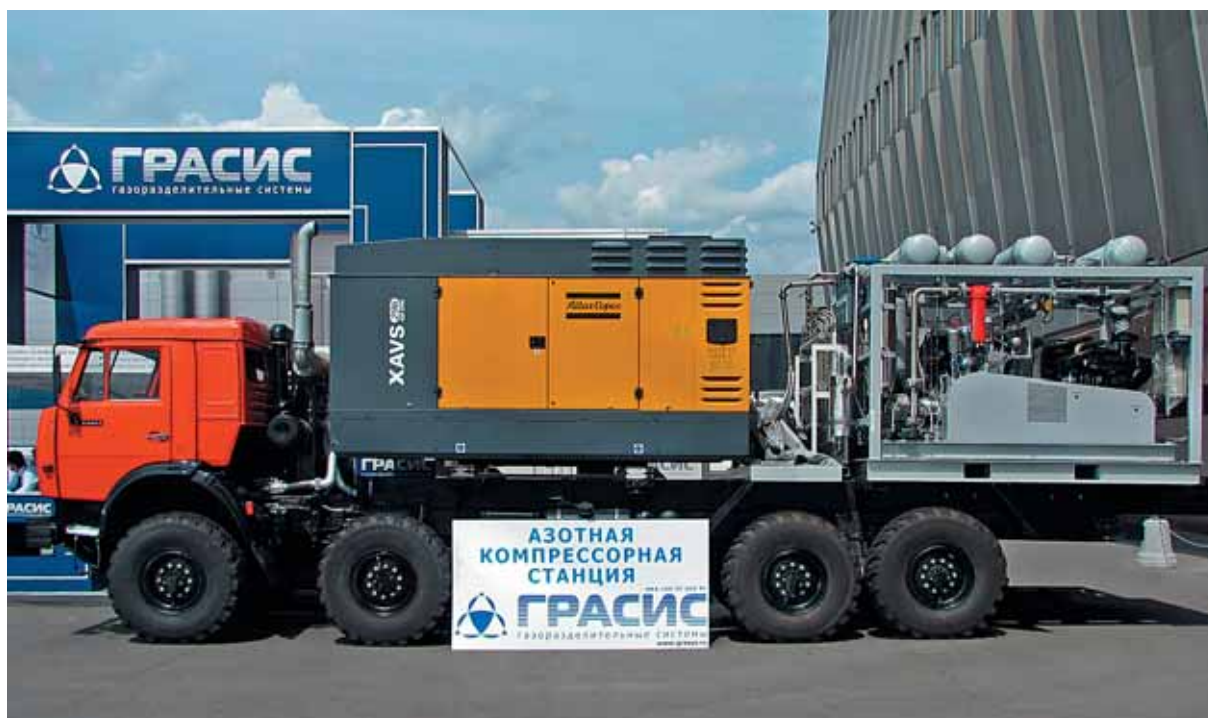
Заказчик — ТОО «Казахойл Актобе». Производительность — 7.5 нм 3 /мин, чистота азота — 95%, давление азота на выходе — до 350 ати.
