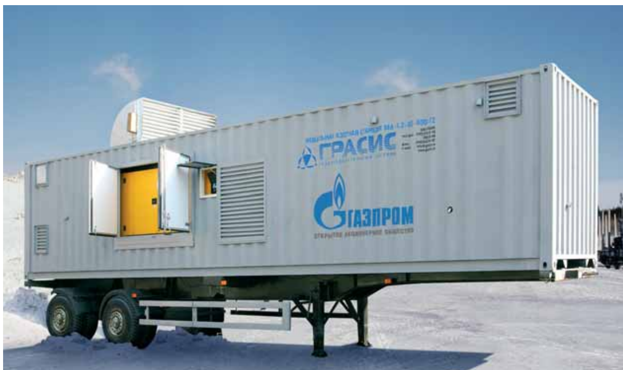
Заказчик — ОАО «Газпром». Производительность — 600 нм 3 /ч, чистота азота — 95%.
