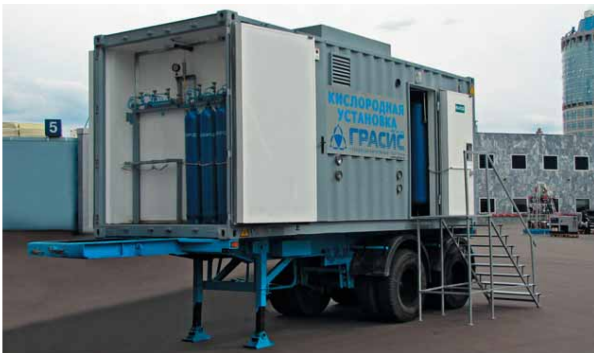
Заказчик — ООО «Движение». Производительность - 25 нм 3 /ч, 100 балл/сутки, чистота кислорода — 93-95%.
